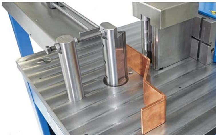
210 Prisma mit integriertem Messsystem für automatisches Nachbiegen
