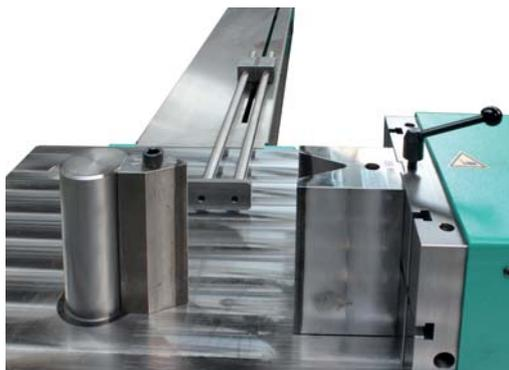
191 CNC-Längenanschlag mit 1m / 2m / 3m
