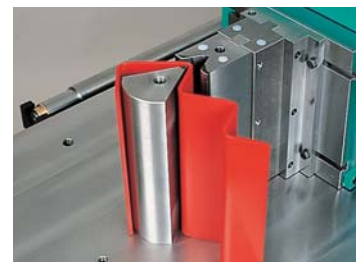
101 Dünnblech biegen Bending light sheet
