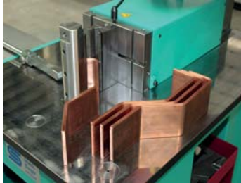
70 Stromschienen Serienproduktion Busbar serial production
