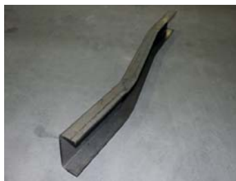
83 U- / L-Profil biegen Bending of U- and L-Profil
