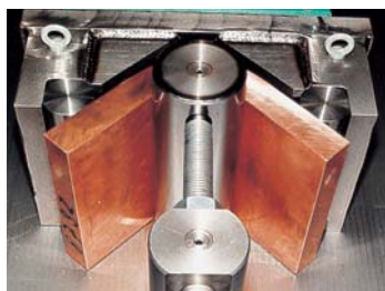
95 Geschweisstes Biegeprisma Welded bending prism
