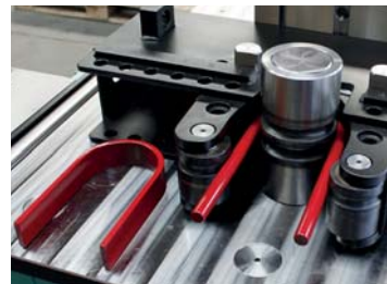
89 Horizontal biegen bis 180° Horizontal bending up to 180°
