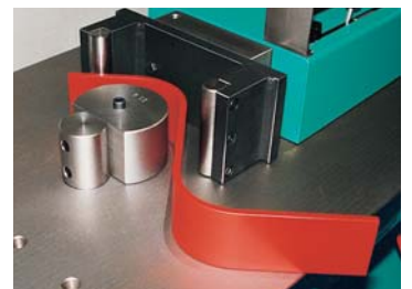
85 Biegen von grossen Radien Large radius bending
