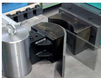
96 Pressbiegen mit Formwerkzeug Press bending with forming tool
