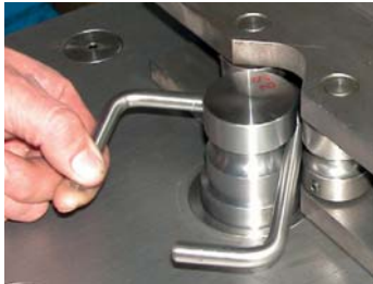
74 Abdruckfrei biegen für Rundstahl Marks free bending f. round steel
