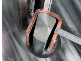
71 Enge Biegungen m. Sonderstempel Narrow section punch
