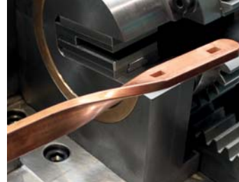
72 Verdrehwerkzeug 90° Torsion tool 90°
